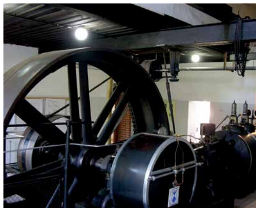
Der Dampfmaschinenverein betreibt eine Tandem-Verbundmaschine der Firma Hanomag Hannover von 1911 und einen Dampfkessel von 1913 der Firma Carl Sulzberger. Das Ensemble besitzt Seltenheitswert und ist deutschlandweit einmalig.
